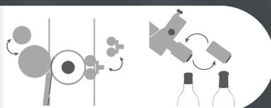
Rouleaux lisseurs et têtes de blocage interchangeables pour s'adapter à vos multiples produits
