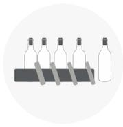
**Rythme alimentation bouteille** adapté à un **niveau de cadence élevé** par vis d'Archimède
