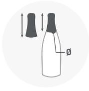
**Hauteur, diamètre et cycle de sertissage réglables et adaptables électriquement**
