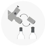
**Gestion de la distribution de capsules** (Ø28 à Ø36) par changement de **godets sur mesure et interchangeables**
