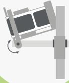
Mise en fonction d'un poste de dessus ou de côté par simple basculement de la noix de réglage (en inclinaison et en angle de pose)
