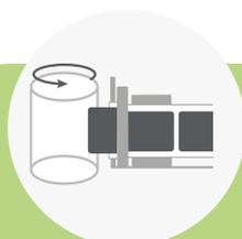
Blocage et mise en rotation des produits cylindriques lors de l'étiquetage
