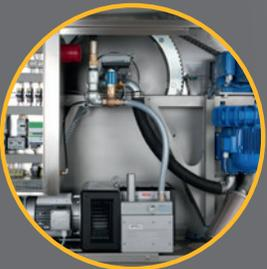
> Centrale de commande avec écran tactile et soufflerie réversible pour une commande de la pression en amont et de l'évacuation très efficace et rentable (en option : compresseur intégré)
