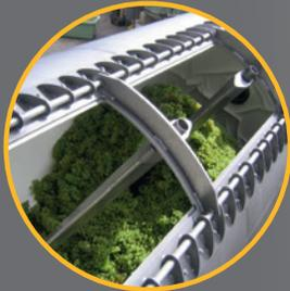
> Grande ouverture de remplissage sur toute la longueur du cylindre de pressurage (trémie en option)
