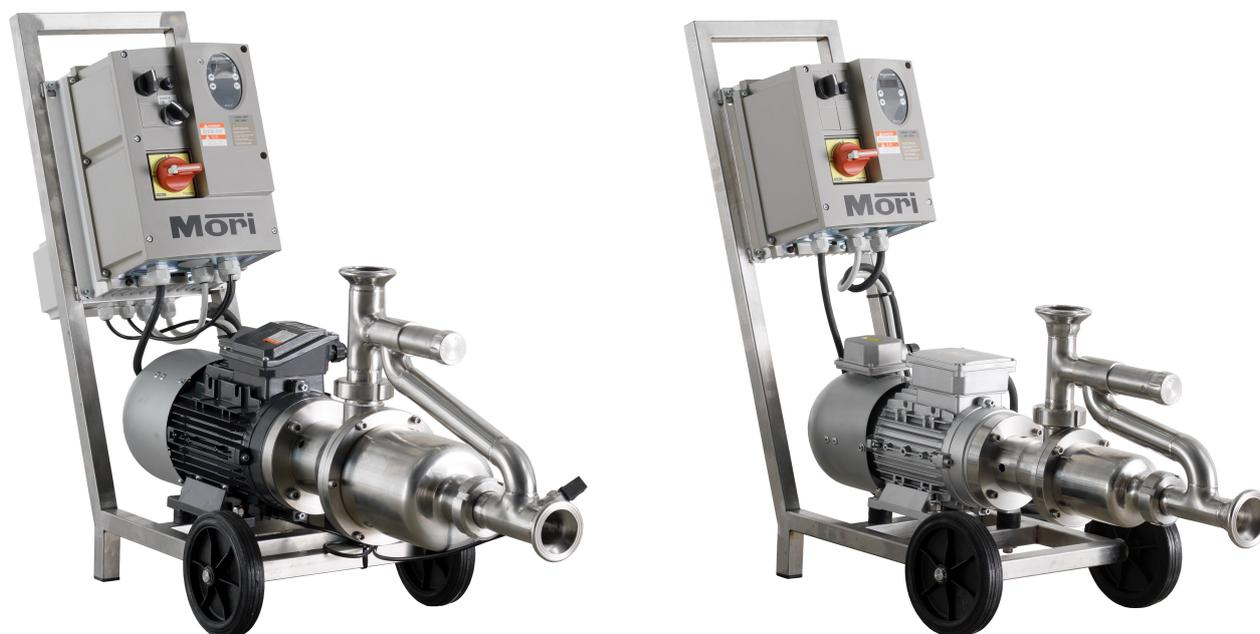
Pompa monovite a statore flottante, carrellate inox, corpo bocca e statore inox AISI 304, motorizzazione servoventilata. Le pompe monovite della serie PM, sono appropriate per il trasporto delicato di fluidi più o meno densi, con o senza particelle solide in sospensione.
